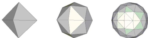
Figura 1: Decomposição da superfície terrestre com grelhas triangulares de resolução zero, um e dois.
