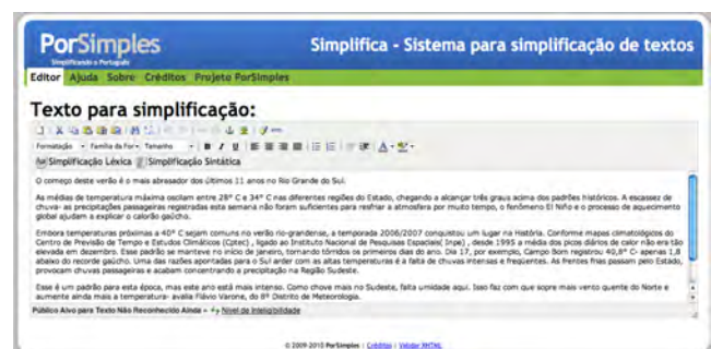
Figura 1: Tela principal do SIMPLIFICA que dá acesso às 3 funcionalidades do editor: simplificação léxica e sintática (no topo, acima do texto) e verificador da inteligibilidade (na barra de status)
